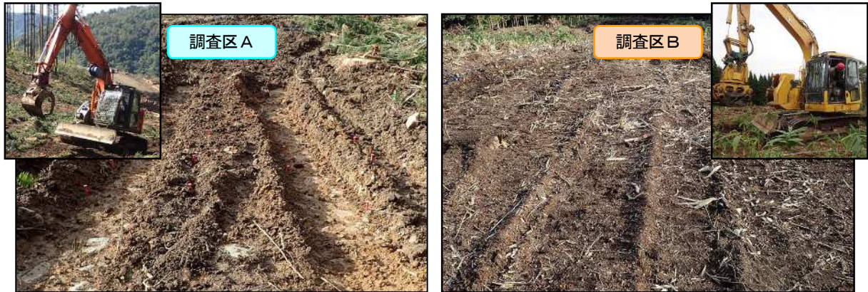
写真 試験に用いた林業機械と走行後の地表面の状態（走行回数：10回）
