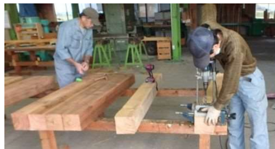
図4 15cm正角材への孔あけ加工
