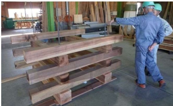
図5 枠材の仮組状況
