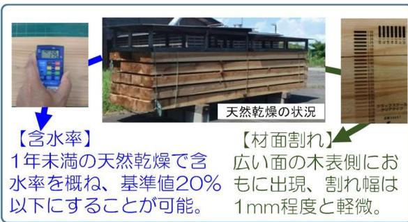
図2 乾燥後の含水率と材面割れの確認
