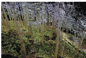
地上型3Dレーザースキャナーを用いた森林評価手法の開発
