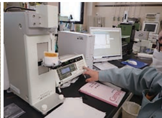
クリープメーターによるかまぼこの物性測定
