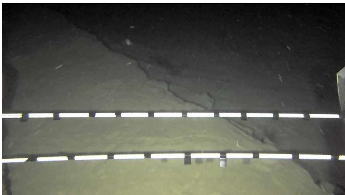
図7 富山湾の魚津沖水深800～900 mで確認された海底地すべりの痕跡。2本のロープには10 cm間隔で目印を付けている。
