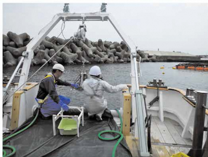
図4 採泥器による採泥作業
