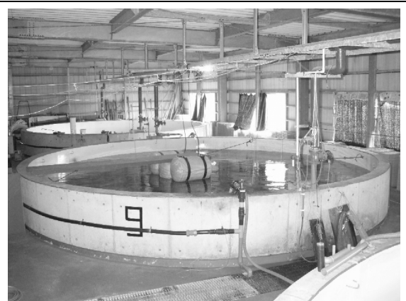
種苗生産試験に用いたヒラメ生産用水槽 (底面積 50 m 2 、最大水量 50 m 3 )
