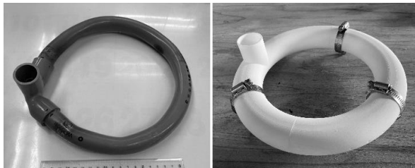
写真 1 円形塩ビ配管(写真左)および3D配管(写真右)の外観
