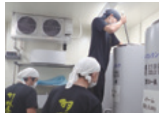
「もろみ」の攪拌作業
