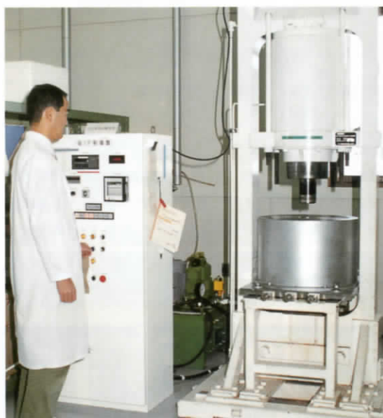
高压処理装置 仕様・性能 神戸製鋼所(株)製WIP型 圧力処理上限：600MPa 圧力処理容積：1,000cm 3 処理温度範囲：室温～60℃
