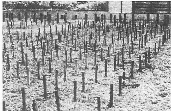
写真-1 杭試験地(新)の外観
