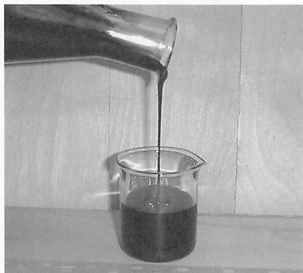
図-3 フェノールによる木材液化物
