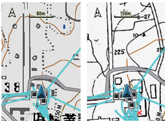
図-3 ガーミンGPSでの森林計画図の表示例 (左：1/25,000地形図，右：森林計画図，縮尺50m以下で自動的に計画図が表示される)
