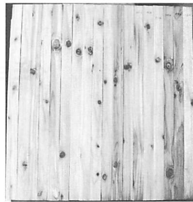
写真-1 注入量測定試片(タテヤマスギ)の外観
