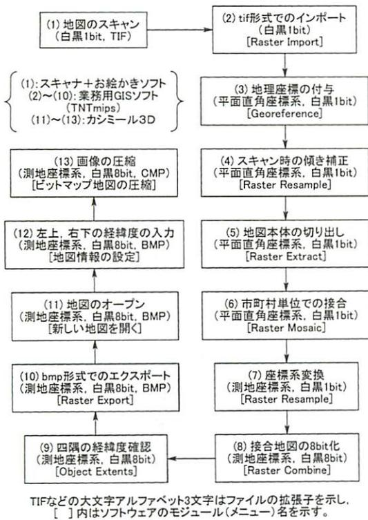
図-2. 森林基本図, 森林計画図の変換手順
