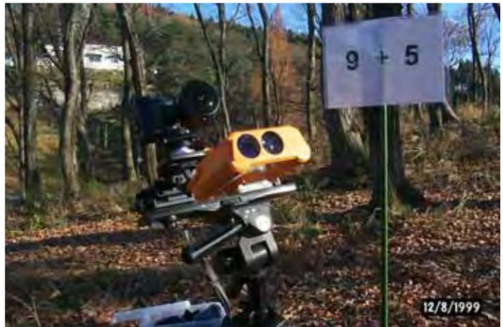
図 2. 測量したい木を二箇所以上の地点から撮影する。写真機 (Nikon Coolpix950) の右は撮影地点の位置と方向を計測するためのレーザーレンジファインダー。その右は測量杭上にたてるターゲット。
