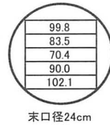
図-3 スギ丸太内からのラミナ採材の1例
