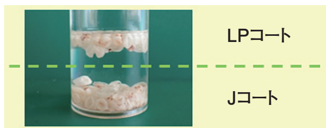
図1 肥料殻の浮き上がりの様子
