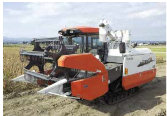
写真2 供試コンバイン 注1) 型式：クボタ ERH450E-CG 注2) ロール式コンケーブ装着
