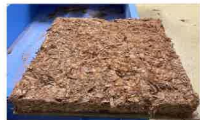
図5 スギ樹皮+モルタル成型物
