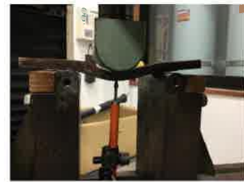
図3 曲げ試験の様子
