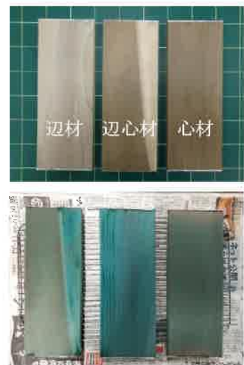
図1 試験体例 (上：試験前、下：試験後)
