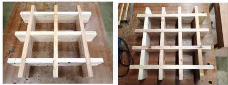
図1 作成した木製格子型路盤安定材（左：6本組A型・右：8本組B型）
