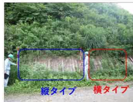
図 1 T線 視距確保効果の検証 縦タイプ（効果あり）横タイプ（効果なし）
