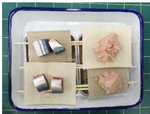
図4 液漏れ試験の状況
