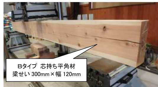
写真3 プレーナ仕上げ後の状況および曲げ強度試験の様子
