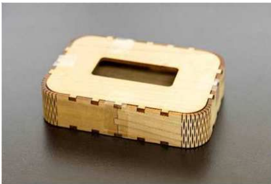
図4 精密レーザー処理による曲げ成型を活かした木製品 (左:ティッシュケース、右:スマホスタンド)
