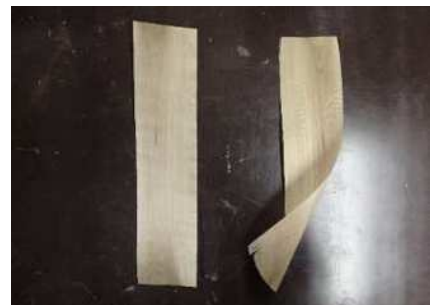
図1 作製したホオノキ薄板 (左：伸ばした薄板、右：未処理の薄板)
