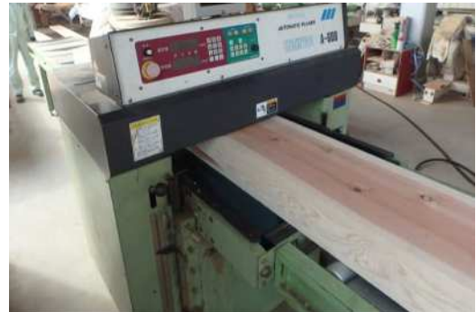
写真2 プレーナ掛けの様子
