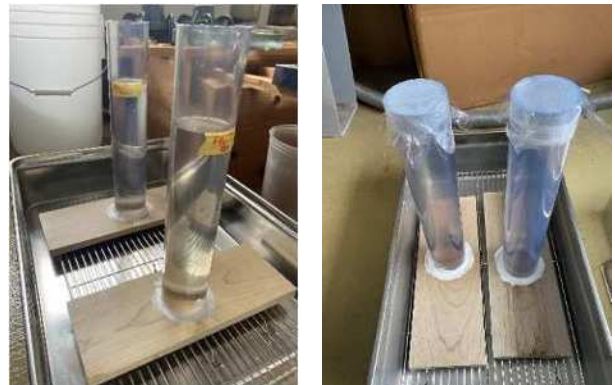
図2 浸透試験（左：水、右：エタノール）
