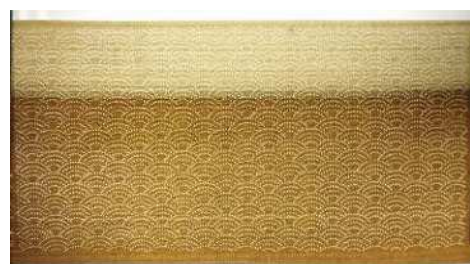
図3 レーザー彫刻したPEG処理ホオノキ薄板
