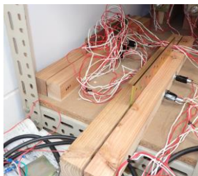
図1 摩擦接合試験体
