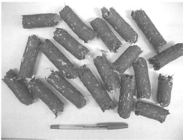
図5 アカマツ樹皮・廃プラスチック固形化燃料の外観
