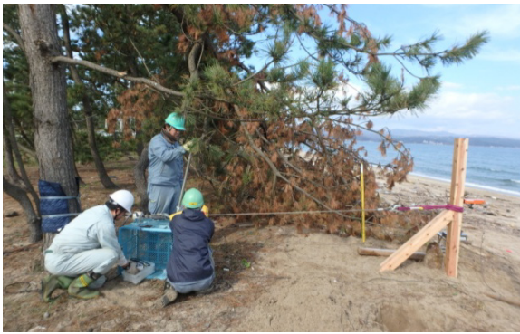
写真2 正方向引き倒し試験の様子
