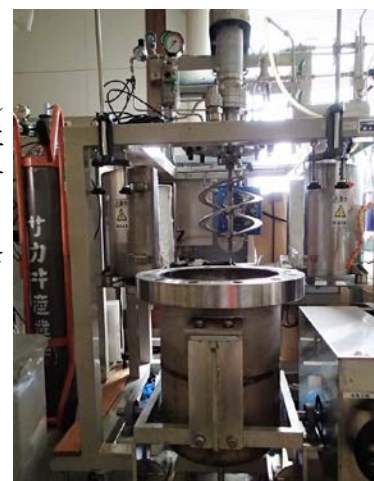
図1 20L反応容器によるスケールアップ検討 ※冷却器を設置して、有用成分の回収を検討。
