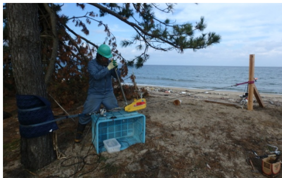
写真5 逆方向引き倒し試験の様子
