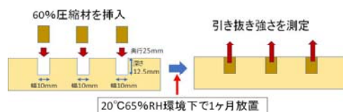
図1 圧縮木材の引き抜き強さの測定方法
