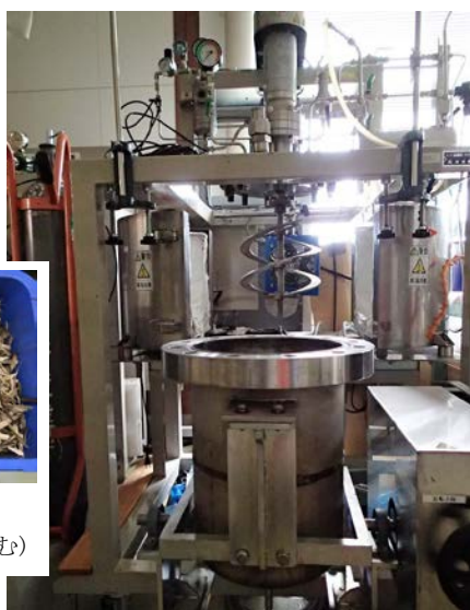
図1 20L反応容器による検討 ※冷却器を設置して、有用成分の回収を検討。
