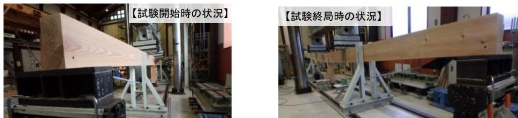
図-3 張弦トラスの曲げ試験状況（左：試験開始時、右：試験終局時）
