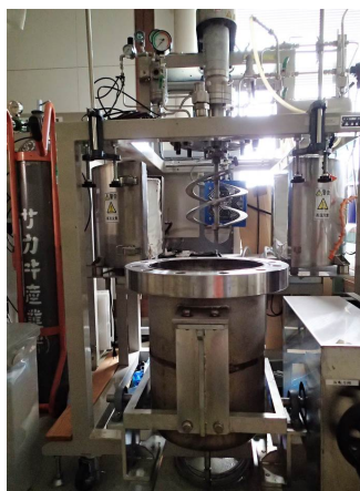
写真1 20L反応容器によるスケールアップの検討 ※還流冷却装置を設置し、有用成分の回収を検討する。
