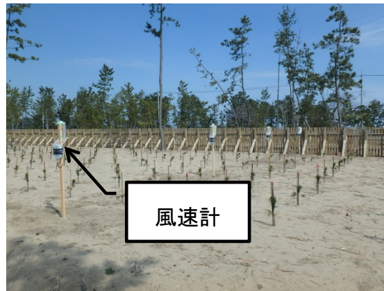
写真 2 風速計の設置状況
