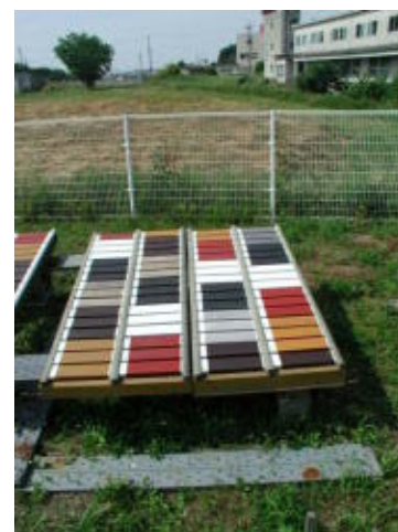
写真 1 塗装した防腐処理木材の屋外暴露試験状況
