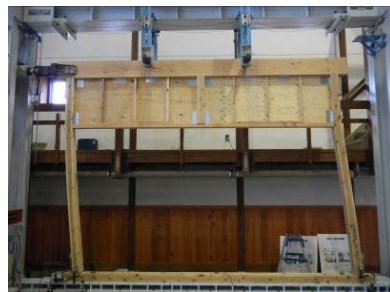
写真2 パネル補強試験体
