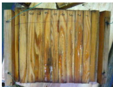
写真2 1年後の辺材 上段の下面(菌糸が発生)
