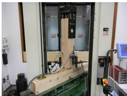
写真1 柱—土台の長ほぞ差し込栓接合部の引張り試験（予備試験）
