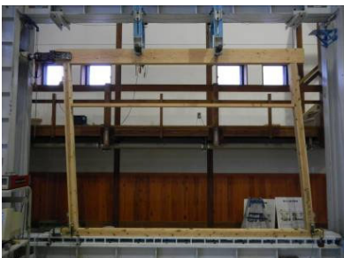
写真1 無補強開口試験体
