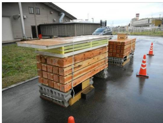
写真1 天然乾燥中の2組の栈積み
