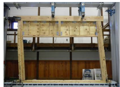
写真3 パネル・柱補強試験体
