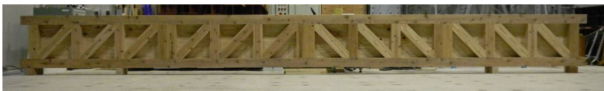
写真1 7m スパン梁（改良IT型）の試作体
