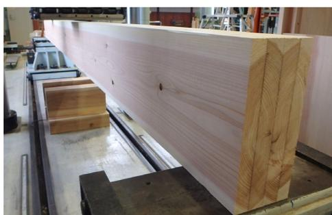
写真 2 試作した縦使い集成材
