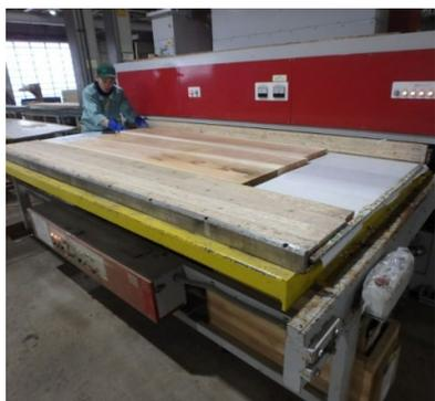
図6 県内工場でのフリー板の製造
