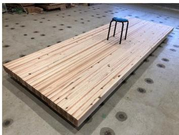
図2 間柱材を用いた実大NLT
