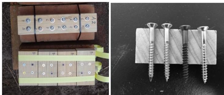
図2 各種材質の接合具を用いた接合木材ユニット
