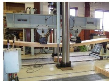
図3 NLTの曲げ強度試験
