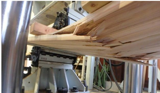
図7 フリー板の曲げ強度試験
