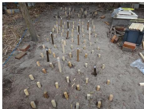
図 1 各種処理ボカスギの野外防蟻試験
