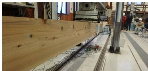
図4 長スパン梁の曲げ強度試験の様子
