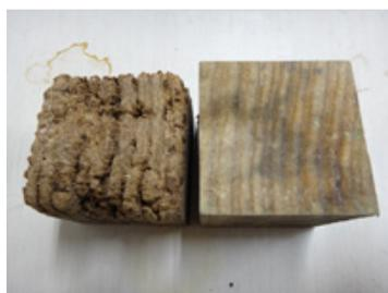
図 1 床下地面に設置した試験体
