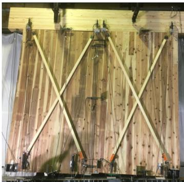
図 1 CLT 連続壁のせん断試験
