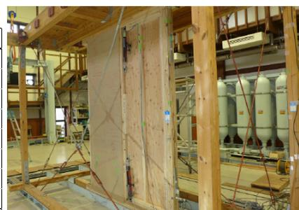
図 2 振動試験の状況
