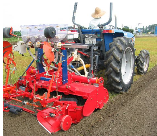
写真 I-2-6-1. 耕うん同時・畝立て・施肥・薬剤散布作業機
