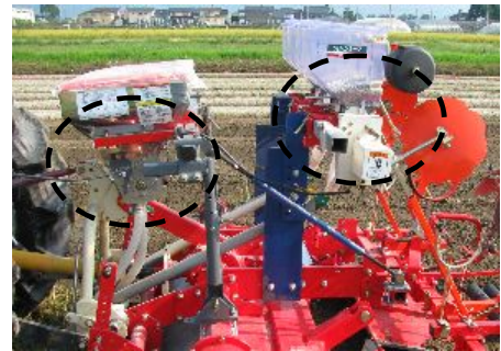
写真 I-2-6-2. 装着した資材散布装置（左）と施肥装置（右）
