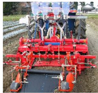
写真 I-2-2-3. 畝再造成と局所施肥・畝上面マルチ被覆作業
