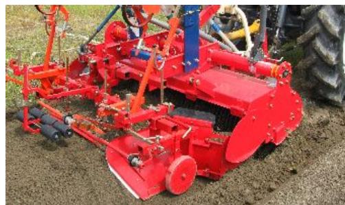
写真I-2-2-1. 耕うん同時畝立て機による畝仮造成作業
