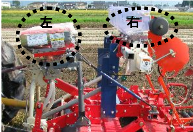
写真 I-2-2-2. 耕うん同時畝立て機に装着した施肥装置 (左：資材散布装置、右：施肥装置)
