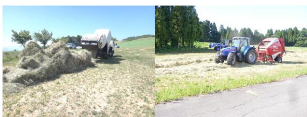
写真4 畜産研究所草地でパッカー車から排出しロールペールで梱包
