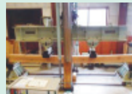
心去り平角材の曲げ試験
